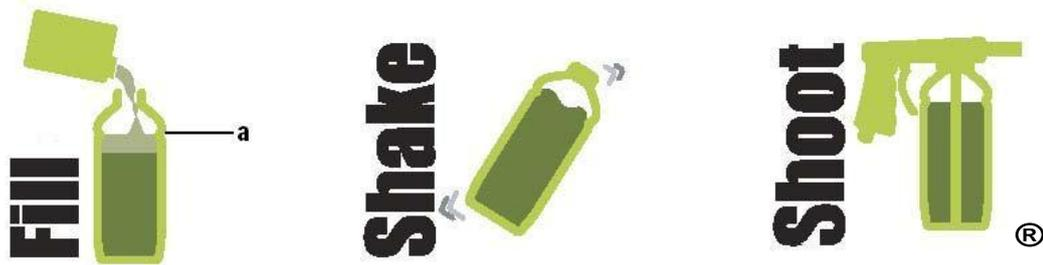
**RELLENAR** con endurecedor hasta el nivel **A** (ver diagrama arriba) de la botella (esto equivale a 250ml del Endurecedor).
