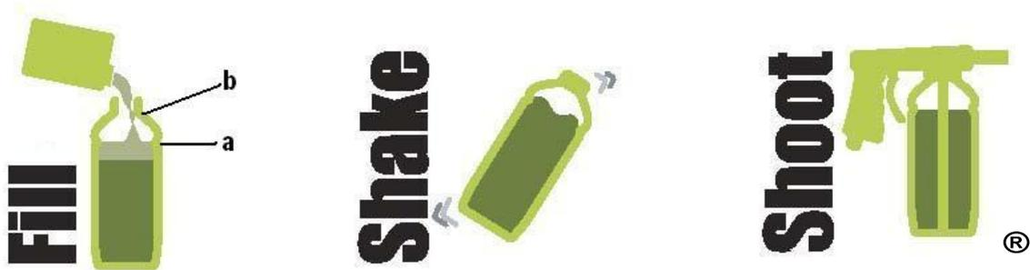
**RELLENAR** con endurecedor hasta el nivel **A** (ver diagrama arriba) de la botella (esto equivale a 250ml del Endurecedor). Después, adicionar la base de tinta (de su elección) hasta el nivel **B** como indicado en el diagrama arriba (esto equivale a hasta 10% de base de tinta por volumen).
